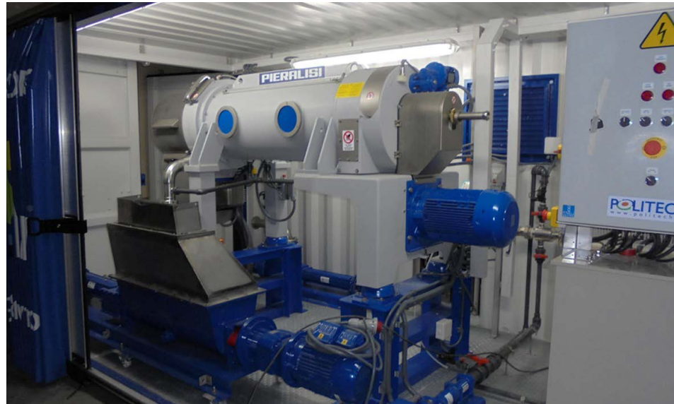
Figura 5.18. Centrífuga para la deshidratación de lodos.
