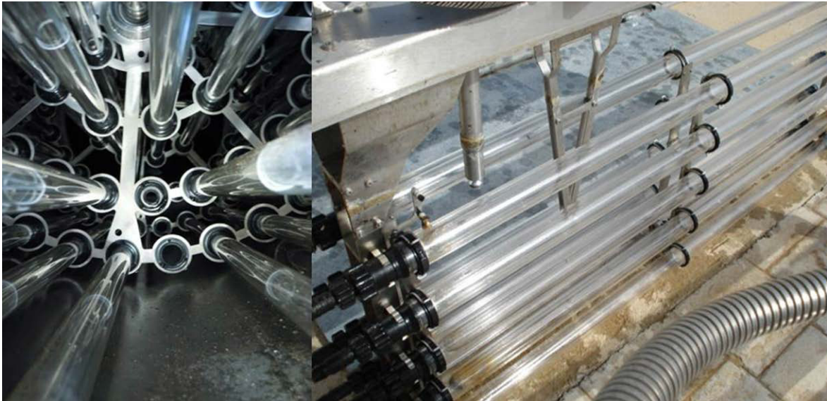
Figura 9.14. Limpieza automática de las fundas de cuarzo en reactores cerrados y abiertos.
