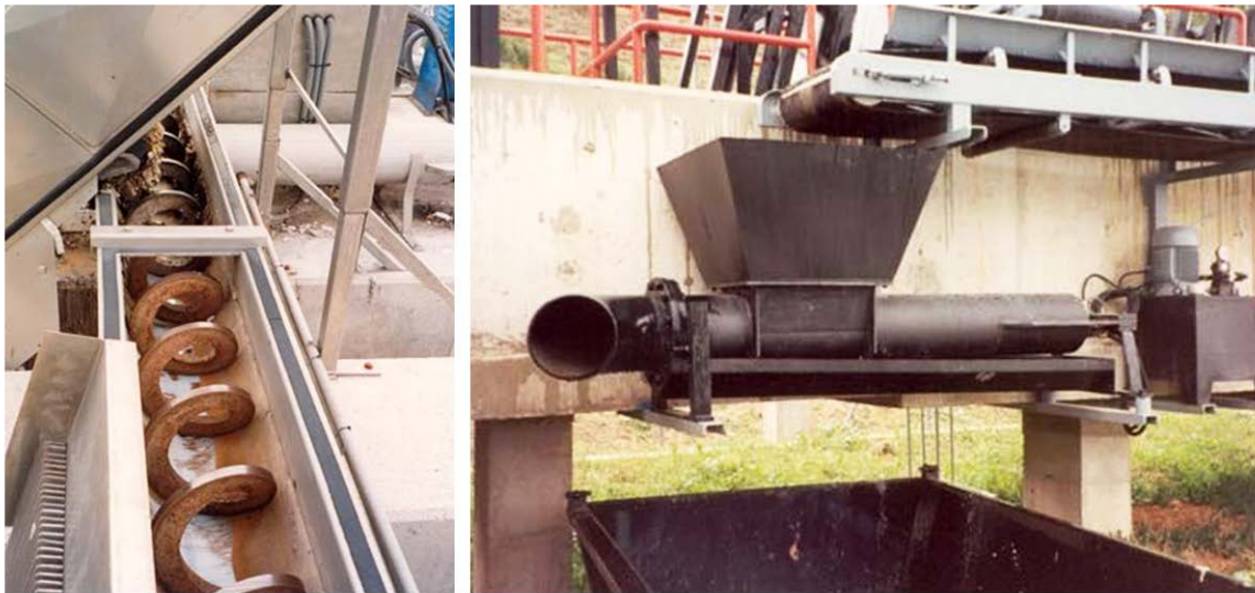
Figura 6.13. Tornillo compactador de residuos y cinta transportadora con prensa (Ortega, 2015).
